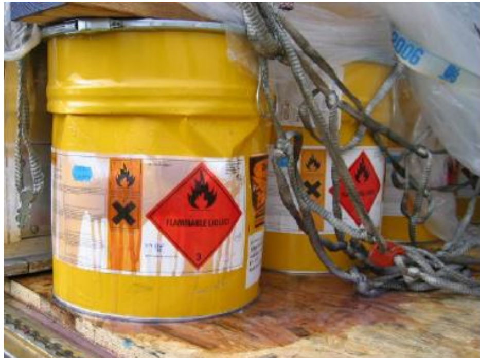
Questo fusto di metallo non ha sopportato il peso della merce caricata sopra.
